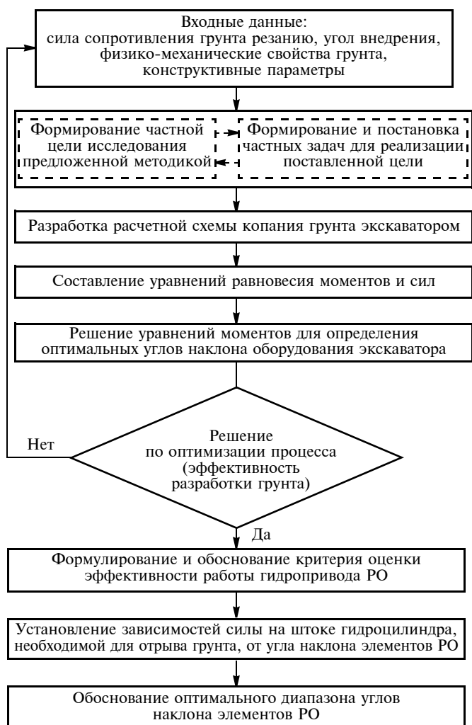
Рис. 1. Алгоритм методики определения оптимальных углов наклона РО экскаватора
